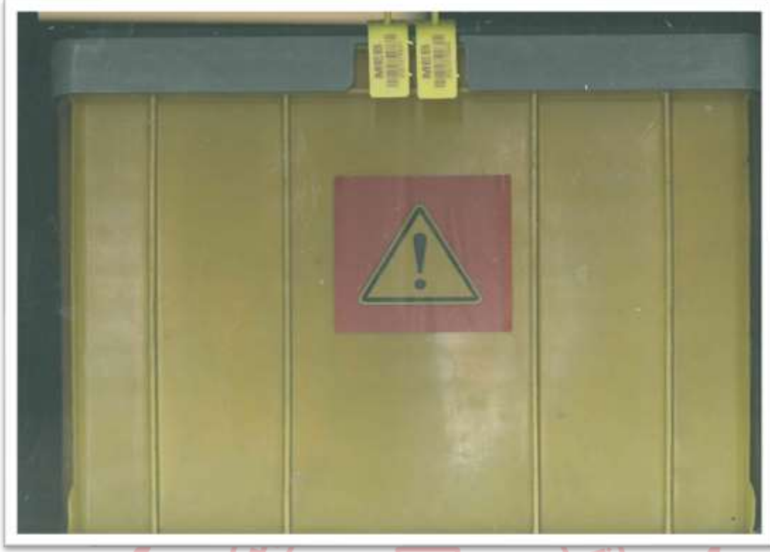
Resim 20: Dönüş kutusunun iki tarafına takılması gereken plastik kilitlerin ikisi de tek tarafa takılmış.
